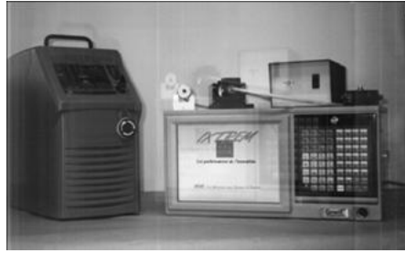
Figure 8 - Système de contrôle ultrasons laser / EMAT (possibilité d'utiliser un PC portable)
