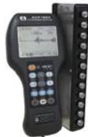
Figure 6 - Système compact de détection de défauts type fissure de fatigue par ondes guidées à contact sec (zone de test jusqu'à 30m)
