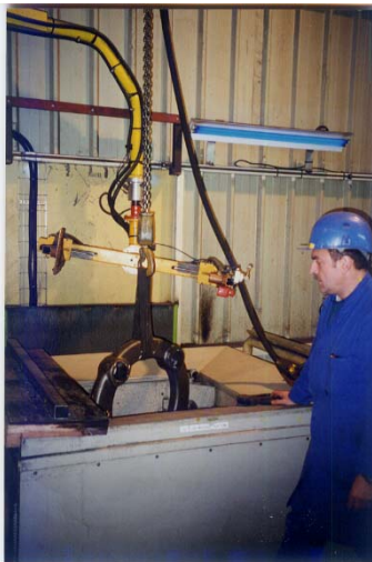
Figure 1 - Technique du puits vertical d'aimantation 3D par champ magnétique tournant
