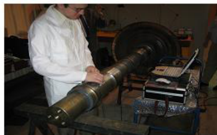
Figure 7 - Techniques ultrasons par ondes de surface (laser -transducteur par couplage sec)
