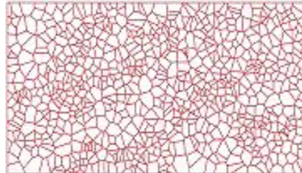
Figure 9 : Exemple de description de la microstructure par des diagrammes de Voronoï (20x10 mm 2 – taille de grains 500µm)
