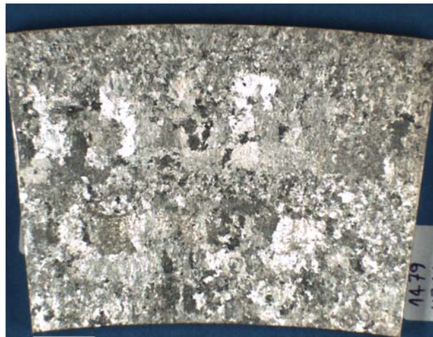
Figure 3 : structure du matériau contrôlé – épaisseur 68,5 mm
