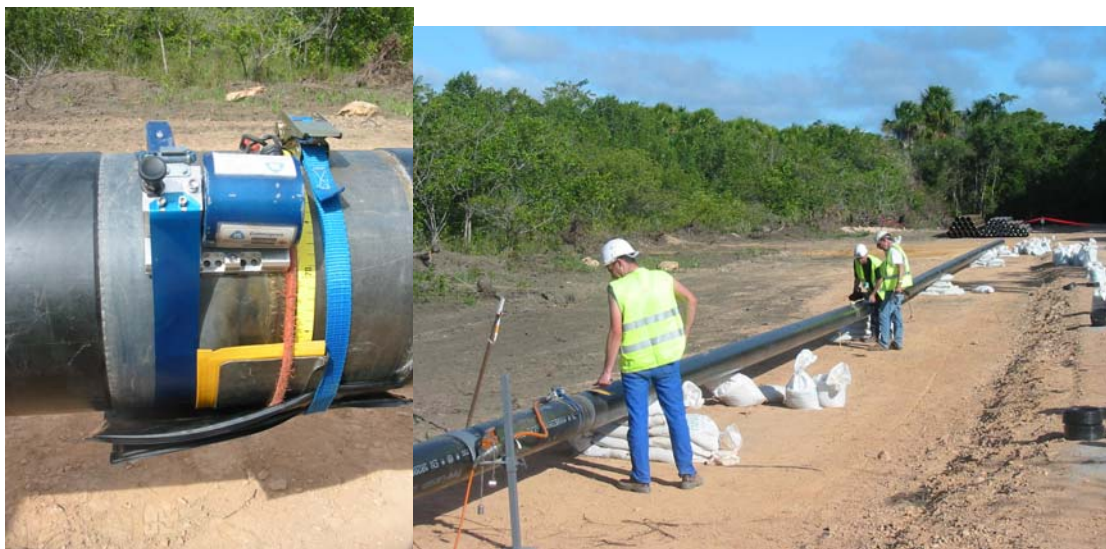
Fig xx : Le \gamma -Prox (version contact) en situation de contrôle sur une canalisation DN 250 - Chantier en Guyane
