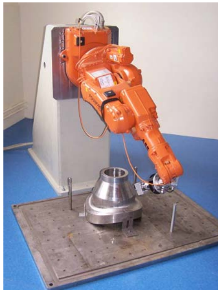
Figure 3 : robot 6 axes installé sur GERIM pour le contrôle de pièces complexes
