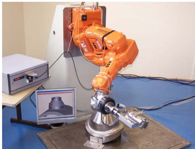
Figure 1 - Installation END actuelle et son remplacement par un robot poly articulé avec simulation sous DELMIA
