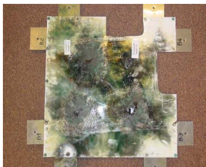
Figures 3, 4 et 5 - Foudre simulée sur une pièce en matériau composite avec plus de 300 microns d'épaisseur de peinture, à gauche face foudroyée, au centre face opposée endommagée, à droite agrandissement de l'endommagement de types multi-délaminages et perforation.
