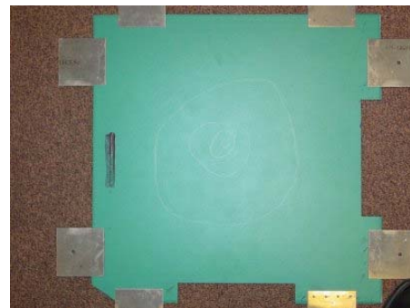
Figures 1 et 2 - Foudre simulée sur une pièce en matériau composite avec 60 microns d'épaisseur de peinture, à gauche face foudroyée, à droite face opposée saine.
