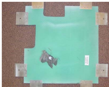
Figures 3, 4 et 5 - Foudre simulée sur une pièce en matériau composite avec plus de 300 microns d'épaisseur de peinture, à gauche face foudroyée, au centre face opposée endommagée, à droite agrandissement de l'endommagement de types multi-délaminages et perforation.
