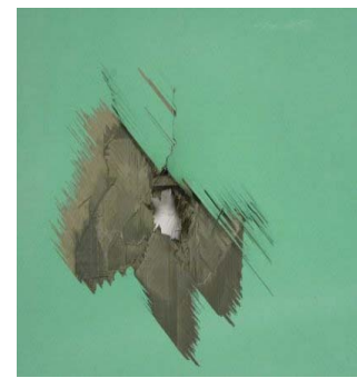
Figures 3, 4 et 5 - Foudre simulée sur une pièce en matériau composite avec plus de 300 microns d'épaisseur de peinture, à gauche face foudroyée, au centre face opposée endommagée, à droite agrandissement de l'endommagement de types multi-délaminages et perforation.
