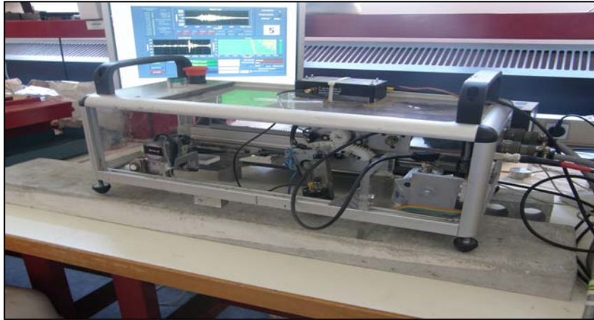
Figure.1. Dispositif pour la mesure des paramètres de l'onde de surface (Safinowski et al 2007)
