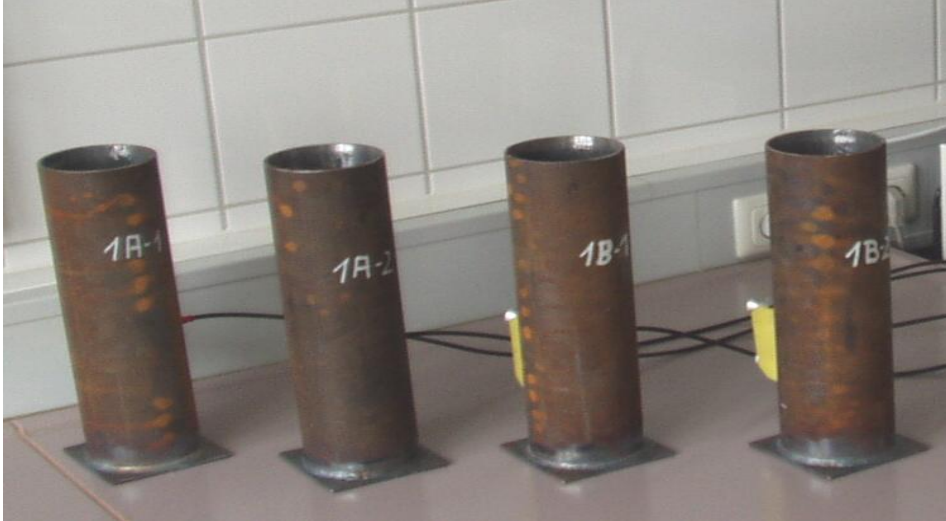
Abbildung 7 Versuchsanordnung Korrosionsversuch, TÜV Nord MPA Leuna
