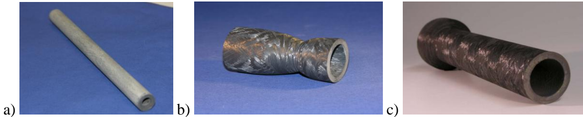
Bild 1 Thermisch und tribologisch hoch belastete Bauteile aus Faserverbundkeramik: a) Kolbenstange für Stoßdämpfersysteme, b) Heißgasdüse, c) Brennerrohr
