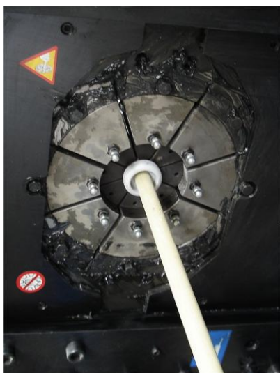
Bild 1 Aufpressen einer Armatur auf einen Stab
