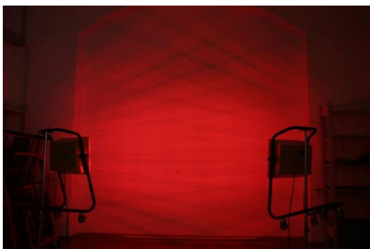
Abb. 1 Infrarotstrahler zur Erwärmung einer Wandoberfläche, Labor
