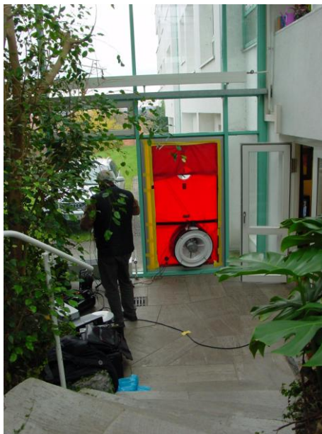
Einbau der BlowerDoor-Meßvorrichtung in eine Tür nach Osten in der untersten Ebene der die beiden Pflegeetage verbindenden großen Glashalle
