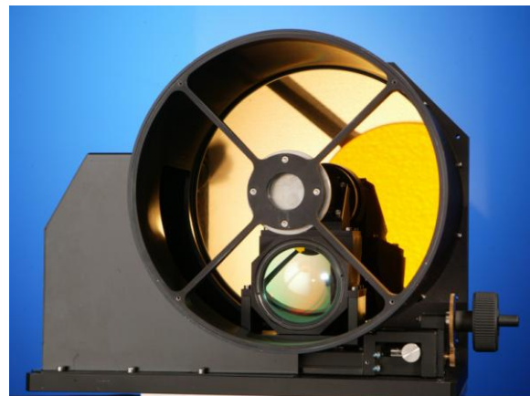
Abb. 1: Dual-Band IR-Kamera Geminis 110k ML mit einem f=100 mm Objektiv (links). Das Dual-Band/Dual-field-of-view-Objektiv mit f=86/390 mm wurde speziell für diese IR-Kamera entwickelt (rechts).
