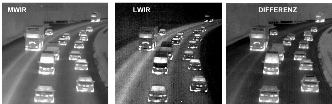
Abb.4: Dual-Band IR Aufnahme einer Autobahn bei Nacht. Links: MWIR, Mitte: LWIR, rechts: Differenz zwischen MWIR und LWIR. Das Differenz-Bild zeigt klar, dass die Windschutzscheiben und die Frontlichter eine höhere Strahlung im MWIR als im LWIR zeigen.
