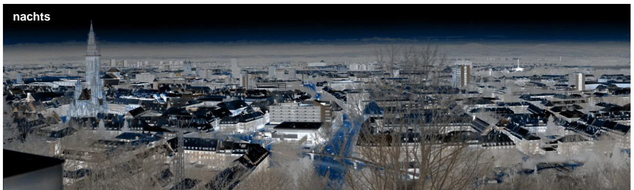
Abb. 2: Dual-Band IR Aufnahmen (3000 x 900 Pixel) der Stadt Freiburg, tagsüber (oben) und nachts (unten). MWIR Bild und LWIR Bild wurden mit Komplementärfarben überlagert. Die Panoramabilder wurden aus ca. 100 einzelnen Aufnahmen zusammengesetzt.
