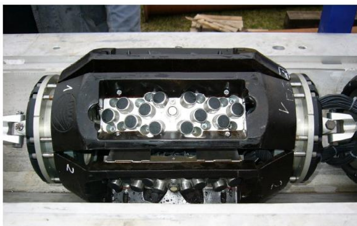
Abb. 10: 10"-Sensorträger für die Inline-Prüfung auf Umfangsrissen. Die Einschallung erfolgt in Laufrichtung bzw. in die dazu entgegengesetzte Richtung.
