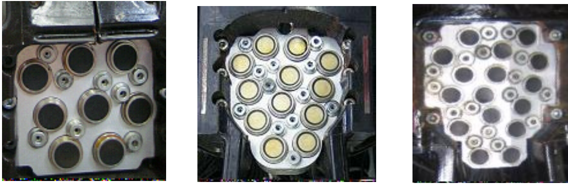
Abb. 5: Prüfkopfarrangements für die Ultraschall-Wanddickenmessung: Standard- (links), HR- (Mitte) und Pitting-Konfiguration (rechts).
