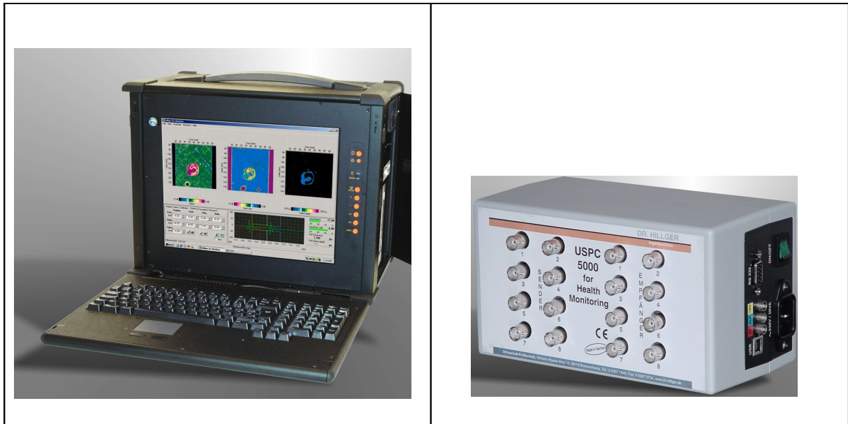
Bild 2: USPC 5000 Portabel mit externer 8-kanaliger Sende- und Empfangseinheit
