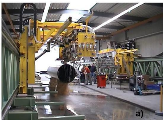
Bild Inbetriebnahme der beiden Schweißnahtprüfanlagen. a) links im Bild die Prüfanlage zur Vorprüfung mit zwei Prüfwagen und b) Prüfanlage zur Abschlussprüfung mit drei Prüfwagen und 30 Prüfköpfen.
