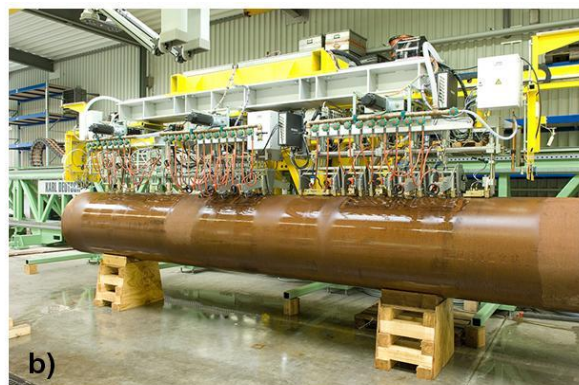
Bild Inbetriebnahme der beiden Schweißnahtprüfanlagen. a) links im Bild die Prüfanlage zur Vorprüfung mit zwei Prüfwagen und b) Prüfanlage zur Abschlussprüfung mit drei Prüfwagen und 30 Prüfköpfen.
