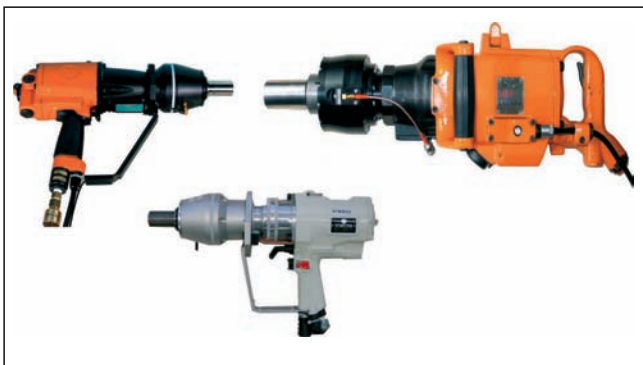
Abb. 10: Handelsübliche Pulsschrauber mit Nuss und Signalübertrager zum gezielten online-Einstellen der Vorspannkraft ohne Fehler durch Reibkraftverluste
