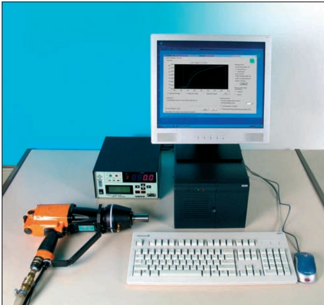
Abb. 9: Handelsüblicher Pulsschrauber mit Nuss und Signalübertrager zum vorspannkraftgesteuerten Anziehen
