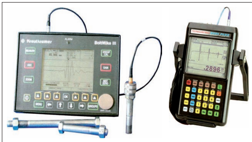
Abb. 1: BoltMike III /6/ und 25 DL PLUS /7/ sind häufig eingesetzte Geräte zur offline Bestimmung der Schraubenvorspannkraft
