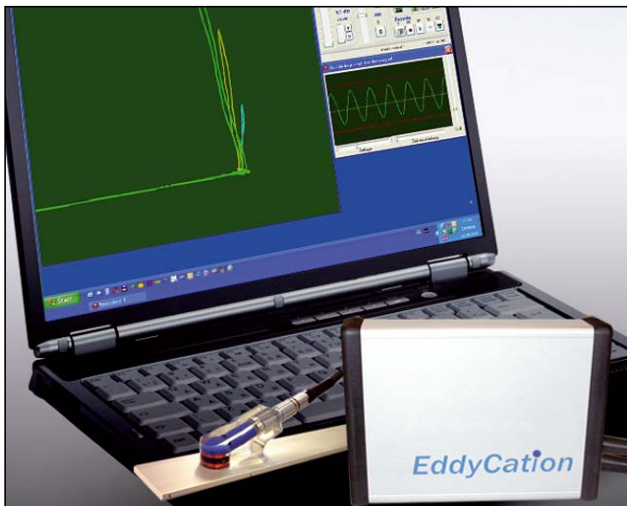
Bild 4: Transparente Sensoren mit breiter Auflagefläche erleichtern das Verständnis und die Handhabung
