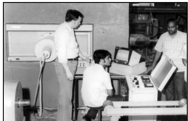
Bild 2: Prüfsysteme mit Bildverstärker/TV-Kamera-Systemen zur Gußteil- und Schweißnahtprüfung (ca. 1970)
