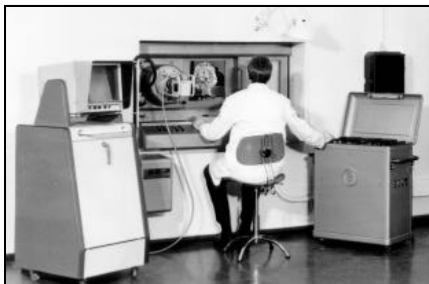
Bild 2: Prüfsysteme mit Bildverstärker/TV-Kamera-Systemen zur Gußteil- und Schweißnahtprüfung (ca. 1970)
