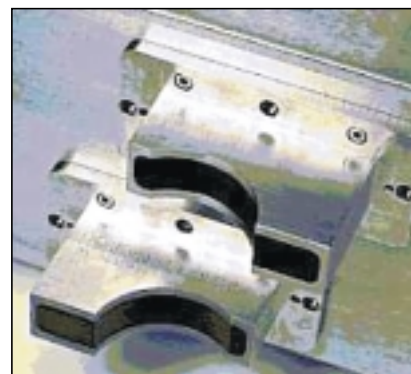
Abb. 14: Prüfkopf-Anordnung für Schweißnahtprüfung
