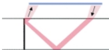
Abb. 16: Arrays in Tandemtechnik zur Prüfung von Schweißnähten
