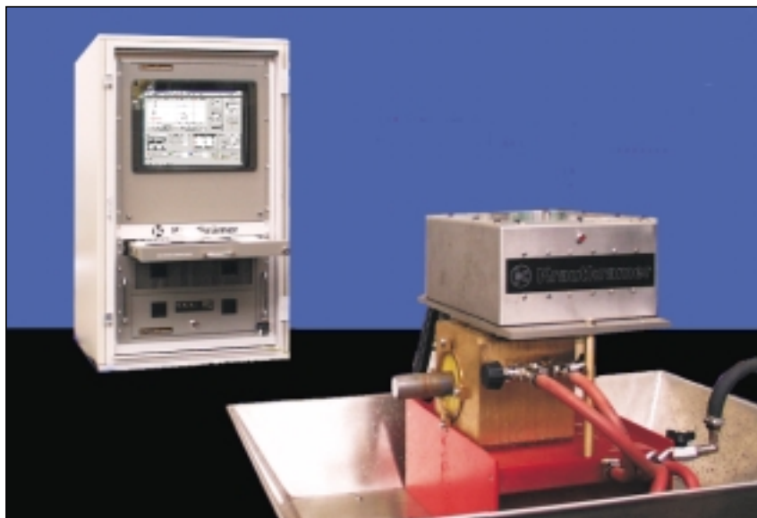
Abb. 15: Rohr- und Stangenprüfanlage in Array-Technik (Modell)
