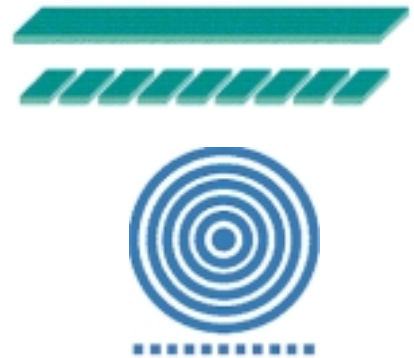
Abb. 1 und 2: Elemente eines Zeilenschwingers und eines Ringschwingers
