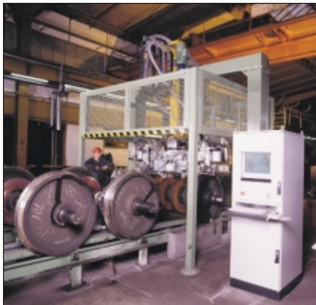
Abb. 2: US-Radsatzprüfanlage AURA im Werk Nürnberg der DB
