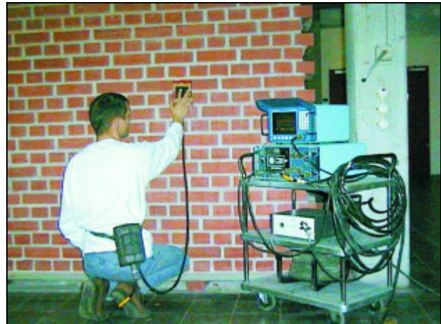
Abbildung 3: Radarmessungen mit einer 1,5 GHz Antenne an Mauerwerk
