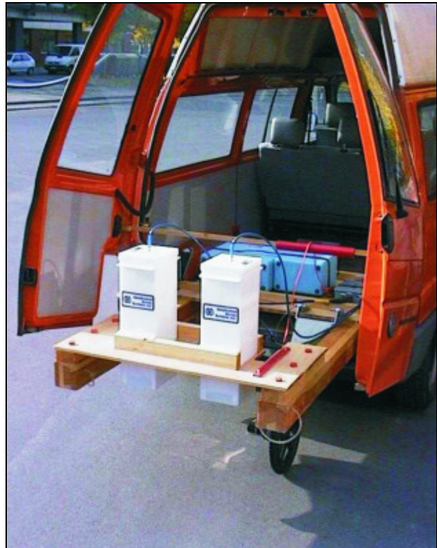
Abbildung 9: Untersuchung von Asphaltbelägen mit Radar bei Einsatz eines 2,5 GHz Hornantennenpaares. Die Messungen können im laufenden Verkehr vom fahrenden PKW aus durchgeführt werden
