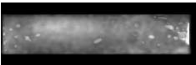
Abb. 2: Angabe der Dichteverteilung und unzulässig großer Poren für einen Schaumzylinder mit 4cm Durchmesser in einem Bild
