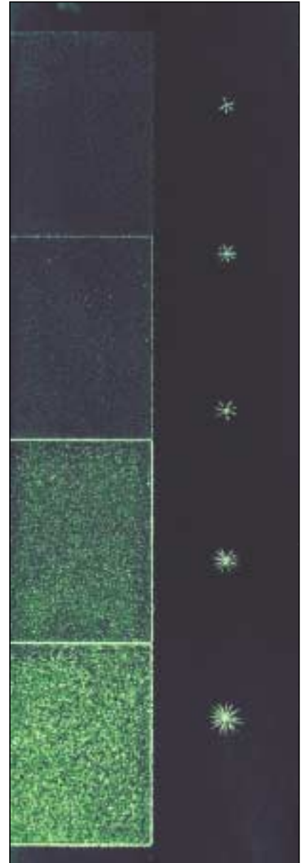
Bild 1: Anzeige eines Kontrollkörpers 2 mit fluoreszierendem Eindringssystem
