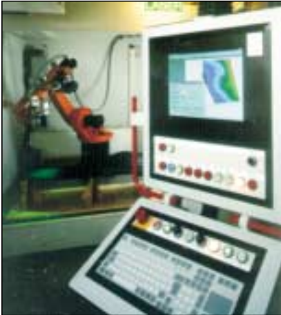
Bild 6: Mobile Prüfanlage für hinter-schäumte Bauteile
