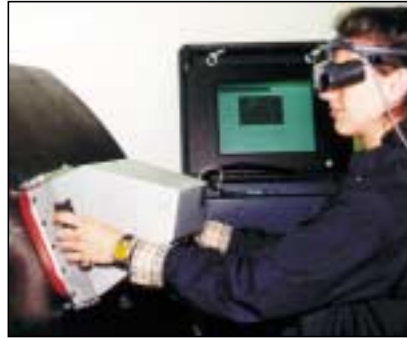
Bild 7: Mobiles shearografisches Vakuumprüfsystem
