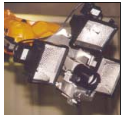
Bild 5: Roboteranbindung des Shearografie-sensors
