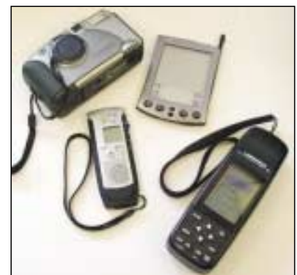
Bild 3: Zur Ausrüstung des Teams der Georgia Tech bei der Datensammlung gehören ein persönlicher Datenassistent, ein kleines GPS-Gerät zur Standortbestimmung, eine Digitalkamera und ein Diktiergerät (das Foto wurde freundlicherweise bereitgestellt von Norris Scott/Georgia Tech ©2002)
