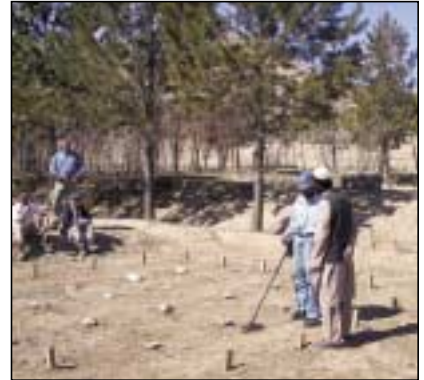
Bild 8: Es wurden sieben verschiedene Metalldetektortypen, je in zweifacher Ausführung und von je zwei verschiedenen lokalen Minensuchern, getestet
