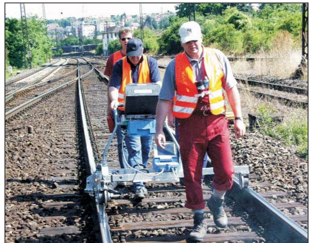
Bild 8: Prüfeinsatz mit Draisine
