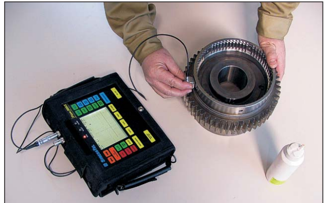
Bild 1: Manuelle Prüfung der Zahnräder nach dem Schweißprozess
