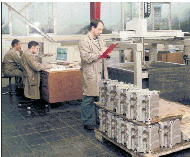
Bild 3: Prüfung von Gussteilen aus dem Verkehrswesen mit Hilfe der Ultraschall-Tauchtechnikanlage im Betrieb der MPV
