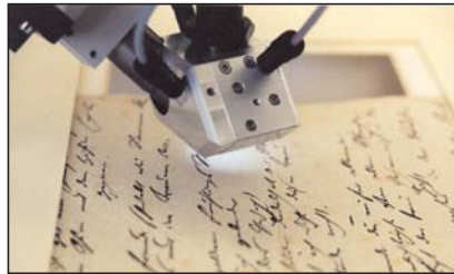
Abbildung 4: ArtTAX-Messkopf über einem Manuskript
