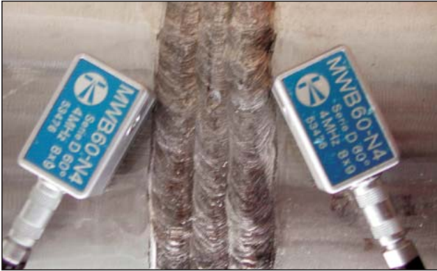
Bild 10: Querfehlerprüfung mit der „Bügeleisen-Technik“
