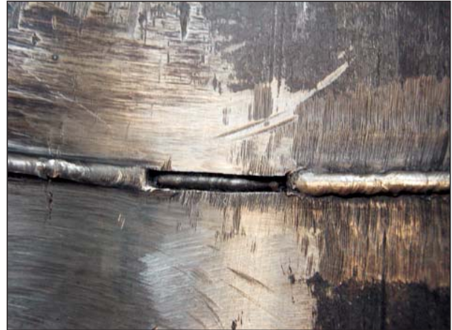
Bild 11: Nicht durchgeschweißte Wurzel
