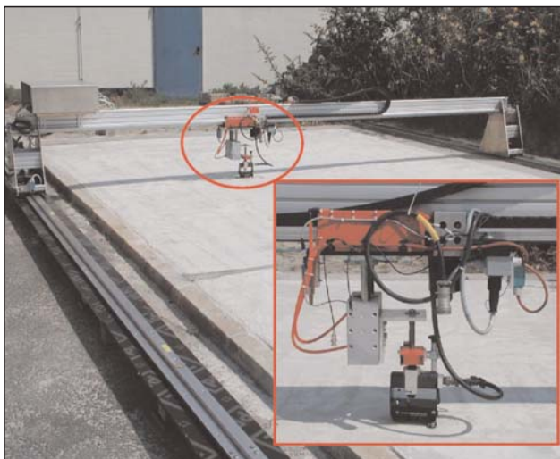
Abb. 1: Modulares Baustellenscanner-System mit multifunktionalem Prüfkopf zur Durchführung von Ultraschall-Echo-, Impact-Echo-Messungen (hier dargestellt) sowie Radarmessungen
