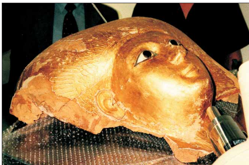
Bild 24: Eine 3600 Jahre alte ägyptische Sargmaske während der Hochenergie-PIXE-Untersuchung
