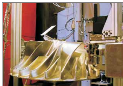
Bild 18: Auch schwere Bauteile, wie dieses etwa 250 kg schwere Verdichterrad eines Schiffsdiesels, lassen sich auf einem speziellen Messstand untersuchen
