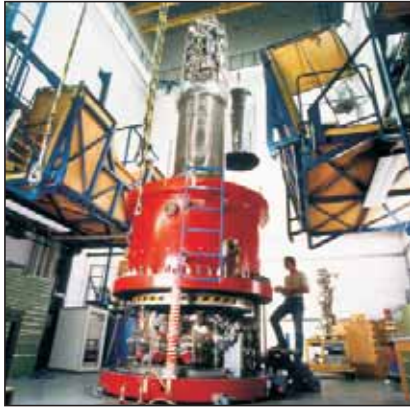
Bild 3: Van-de-Graaff-Vorbeschleuniger am ISL
