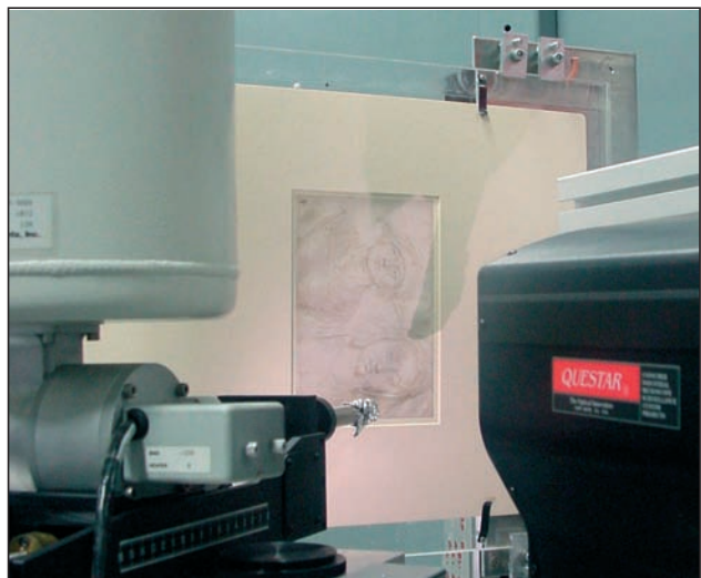
Abb. 2: Experimenteller Aufbau der Synchrotron-induzierten RFA an der BAMline mit der Albrecht Dürer Zeichnung „Marx Ulstat; die schöne Jungfrau von Antwerpen“ 1521 (15269r), Städel, Frankfurt am Main. Links: Si(Li)-Röntgendetektor mit Aluminiumfilter. Rechts: Mikroskop
