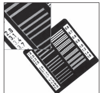
Abb.7 Bildgüteprüfkörper (BPK) bei Zoom 1: Linienpaardia-gramm: 3,1 Lp/mm
