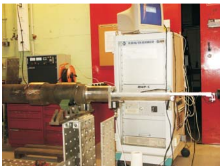
Messaufbau für die Prüfung der Welle mit Längsbohrung mit der Gruppenstrahlertechnik
