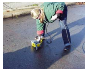
Abb. 2: Messdurchführung am Bauwerk; links: Impact-Echo, rechts: Radar
