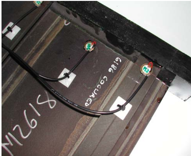
Bild 1: CFK-Bauteil mit Stringern und applizierten Piezo-Elementen
