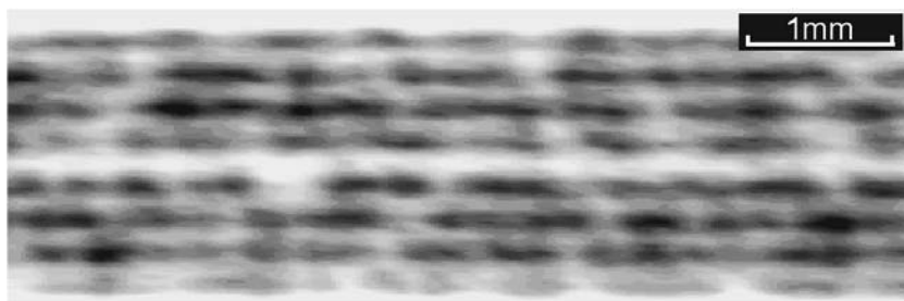
Abb. 3: Transversaler Schnitt durch ein 0°/90°-CFK-Laminat mittels Röntgenbeugungs-Mikroskopie; selektive Verteilung der 90°-Lagen der Kohlenstofffasern (hohe Faserdichte: dunkel)
