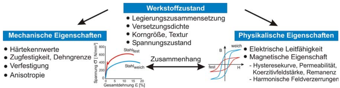
Abbildung 1: Indirekte Bestimmung mechanischer Bauteileigenschaften
