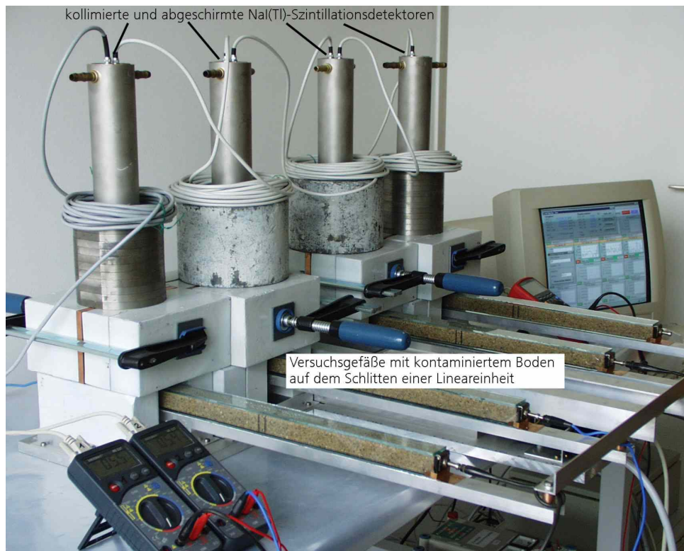
Abb. 1: Fotografie der Versuchsanordnung zur Untersuchung von Transportrichtung und -geschwindigkeit temporär radioaktiv markierter Kontaminanten in Vorbereitung einer elektrochemischen Bodensanierung
