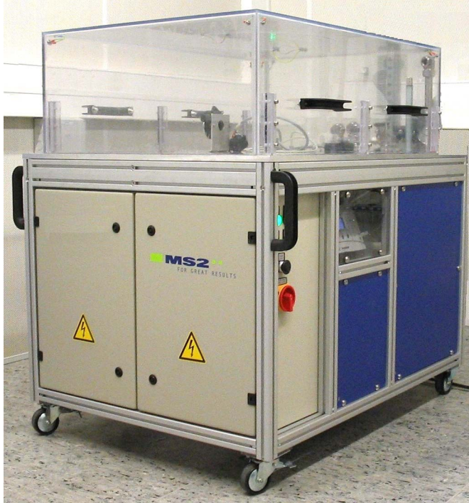
Abbildung 4: Prüfanlage für Brennstoffzellen-Module (MS2 Engineering GmbH)
