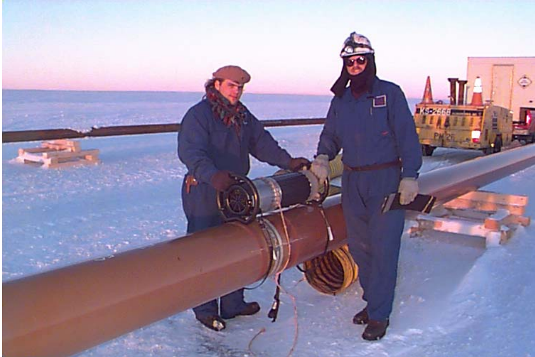
Abbildung 1 Schweißnahtprüfung in der Arktis
