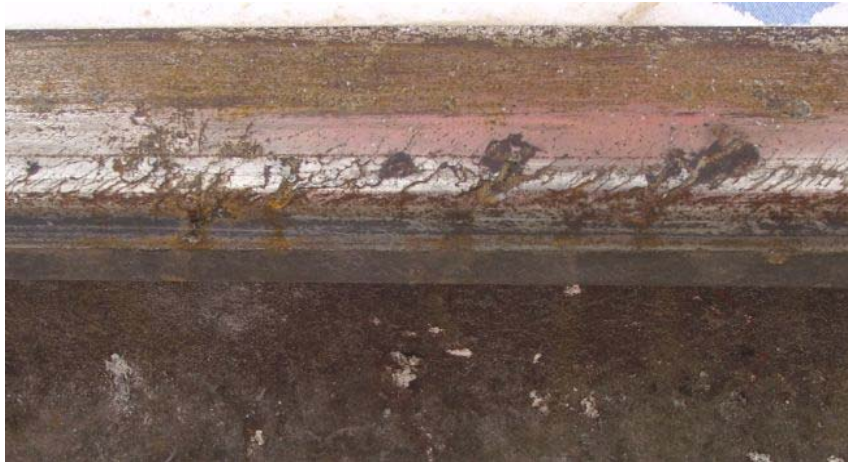
Bild 1: Starke Oberflächenschädigung durch Head Checks
