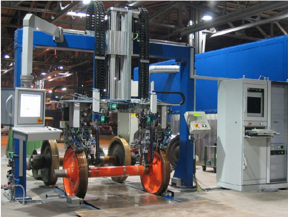
Bild 4: Sensorsystem zur Prüfung von Radkranz und Vollwelle
