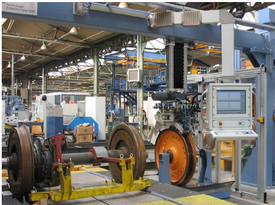
Bild 1: Ultraschallprüfstand für Treibradsätze im DB Werk Krefeld während der Prüfung des Referenzrades
