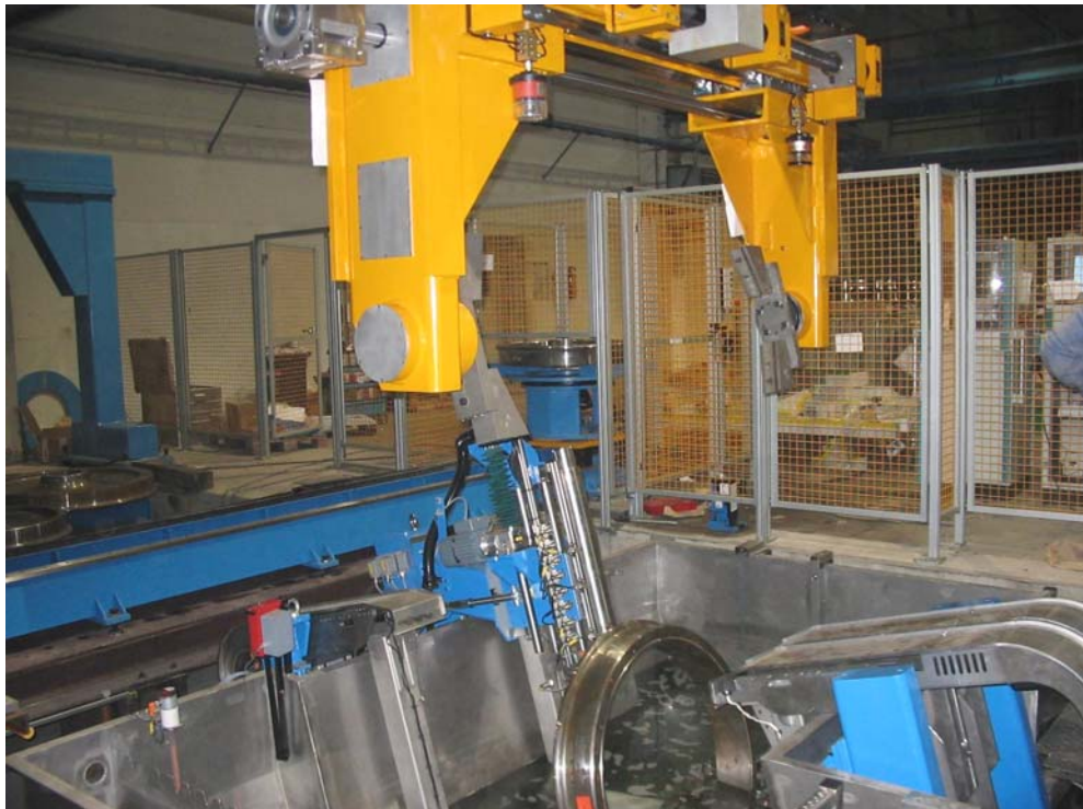
Bild 5: RWI-Radprüfanlage mit eingesetztem Eisenbahnrad während der Unterwasserprüfung
