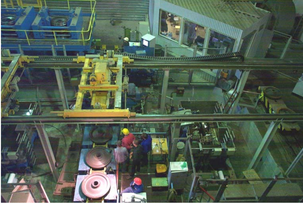
Bild 6: Prüfanlage zur US-Prüfung von Eisenbahnradern mit zwei Kränen und zwei Prüfbecke im NTMK
