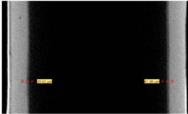
Abbildung 6: Längsschnitt durch die Brennstoffzelle zur Schichtdickenbestimmung
