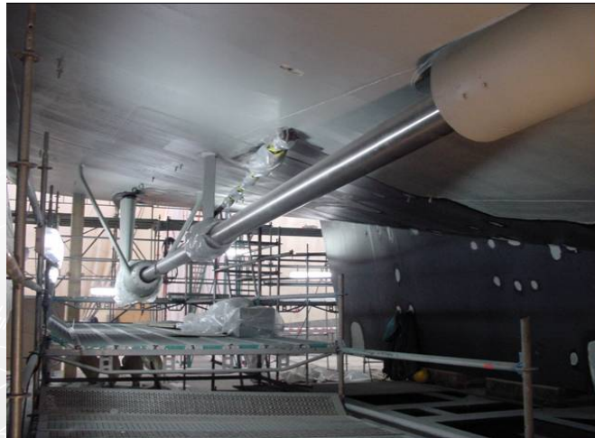
Bild 1: 2 Propellerwellen, Länge 18 m, Werkstoff Duplex- Stahl 1.4462
