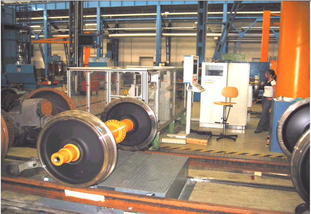
Abb. 3: Prüfeinrichtung für Radsatzwellen mit Längsbohrung im Werk Kassel
