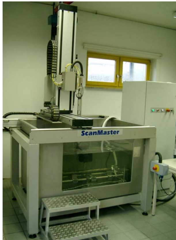
Bild 1: Tauchtechnikprüfsystem der Serie LS500
